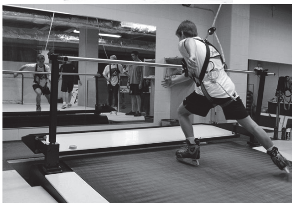
Рис. 1. Тредмил для тестирования и тренировки хоккеистов
